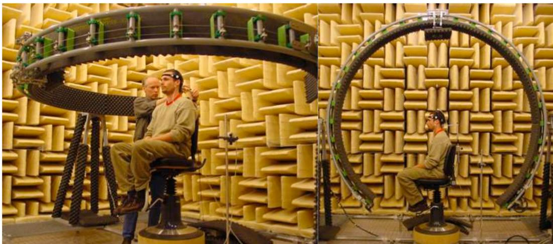
**Fig 20,21** : Mesure d'une HRTF du TNO utilisé pour l'acquisition de la base de Jean-Marie Pernaux<sup>12</sup>
