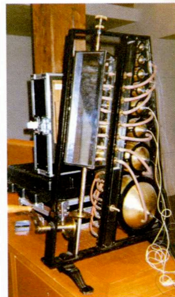
Le Cnam avait mis à disposition son ensemble de résonateurs de Helmholtz pour l'enregistrement des effets sonores et des ambiances utilisés lors du mixage de la dramatique sur Victor Segalen diffusée en surround
