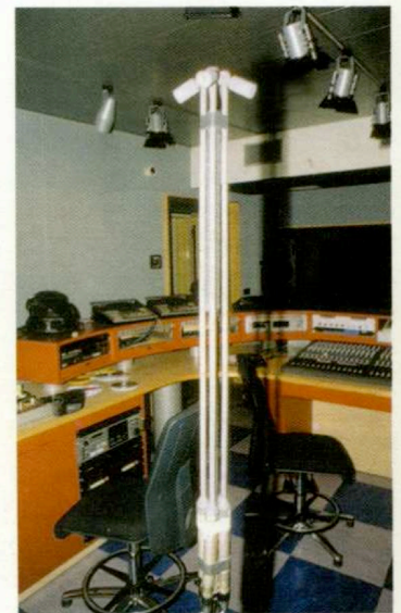
Système imaginé et conçu par Bernard Lagnel : quatre Schoeps MK4 montés sur une perche, alias « la fusée »
