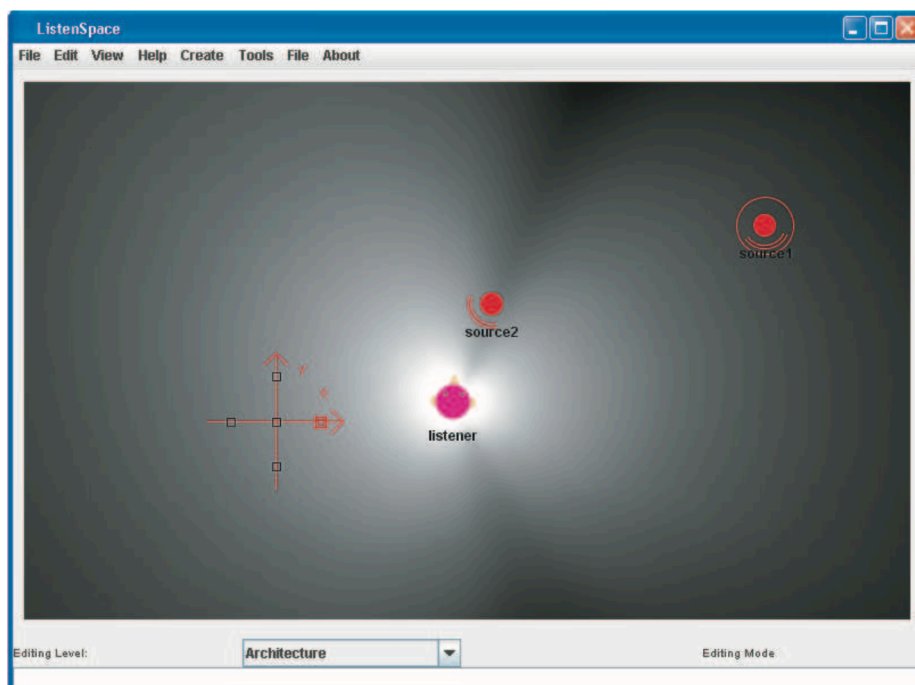
Figure 3.16 : Représentation du masquage spatial sur l'interface ListenSpace . Les zones d'ombres représentent les positions où la spatialisation d'une source sonore serait masqué. Inversement pour les zones blanches. Laurent Simon©2006.
