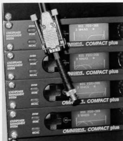
Ensemble des filtres numériques BSS Omnidrive Compact Plus permettant l'ajustement des délais entre enceintes avant et arrière.
