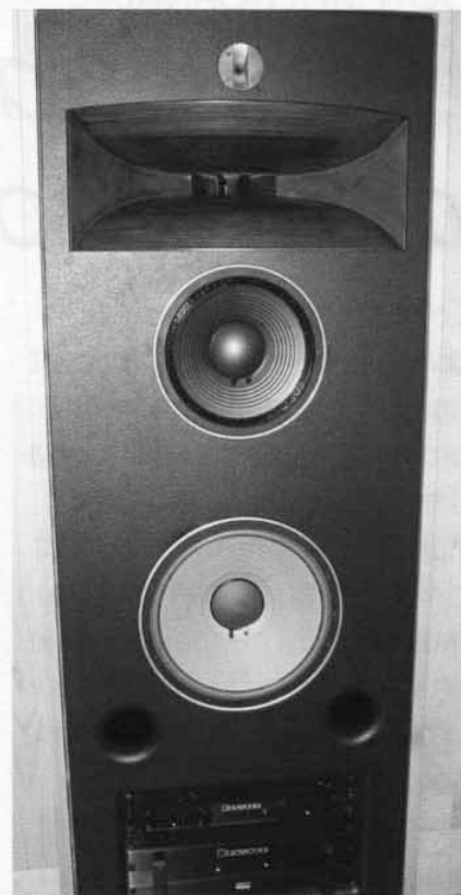
La cabine est équipée de 5 enceintes identiques à 4 voies (HP TAD).
