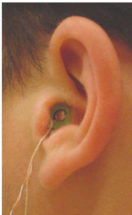
(c) Microphone de mesure : positionnement du microphone dans un moulage du conduit auditif pour une mesure de type "conduit bloqué"
