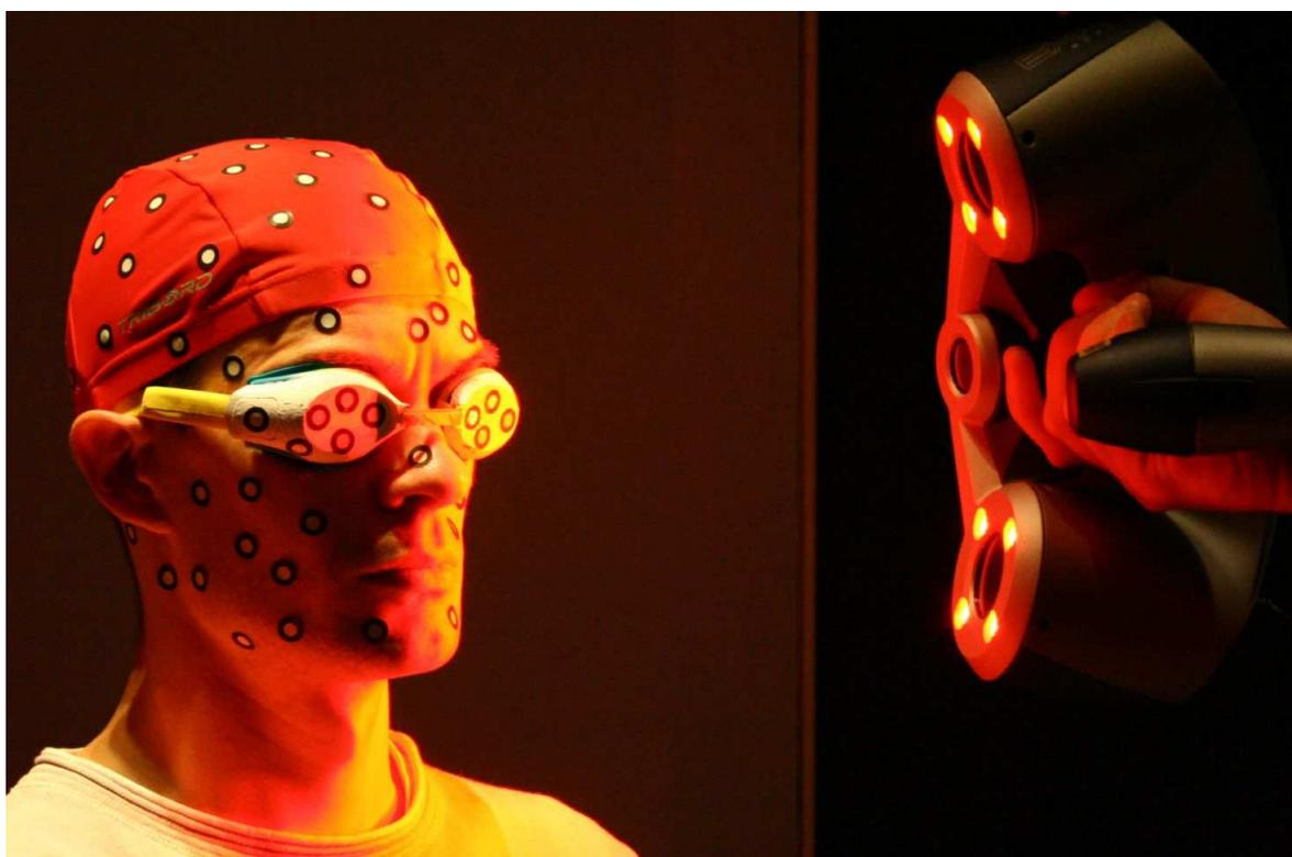
FIG. 3.105 – Acquisition en 3D de la surface de la tête d'un sujet grâce à un scanner laser (d'après [Guillon, 2009]). L'opérateur du scanner le tient dans sa main et tourne autour du sujet.
