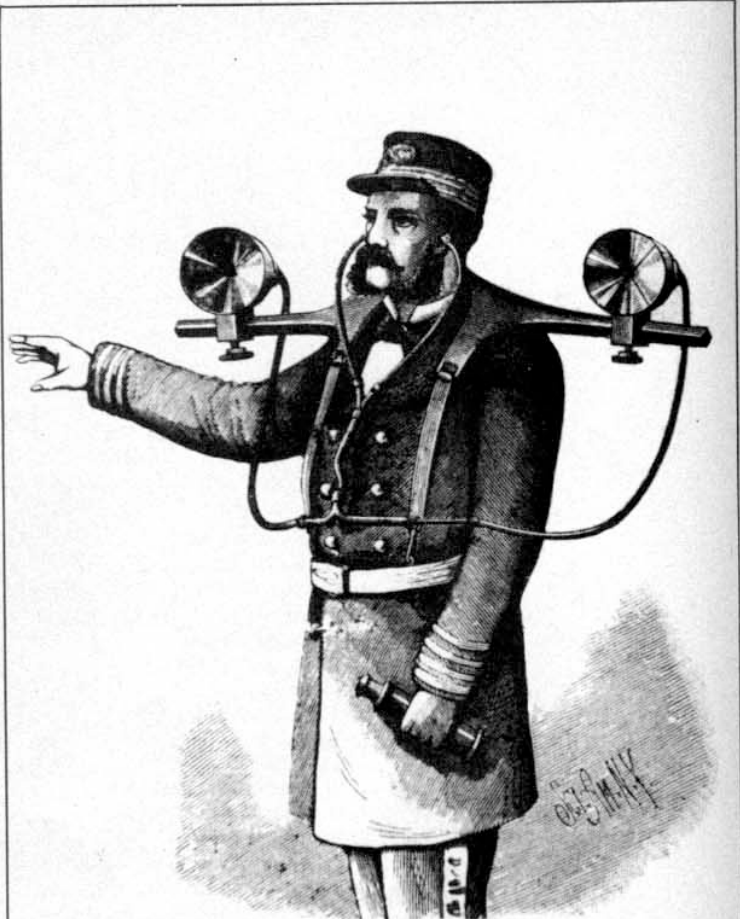
Totophone, appareil permettant une localisation précise en direction et distance, utilisé pendant la guerre 1914-1918. Il fallait, bien sûr tenir compte de la vitesse du son. C'est un des premiers systèmes mettant à profit le pouvoir directionnel de l'oreille. (Document Life).
