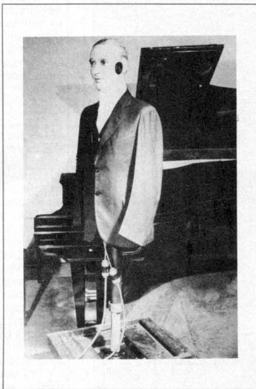
Le fameux mannequin surnommé "OSCAR", qui servit aux premières expériences de localisation binaurale. (Bell Systems Laboratory, 1930) (Document LIFE).
