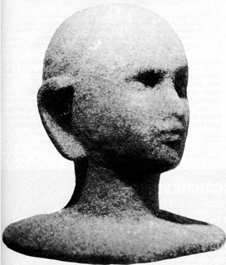
Fig. 9 Tête artificielle Hiraga, une amélioration d'un modèle datant de 1963. La forme des pavillons, des oreilles et surtout la présence du réflecteur inférieur, simulant les épaules, ont été choisis pour la meilleure localisation dans le sens vertical, en particulier pour les sons venant du dessus. Les microphones utilisés ont un diamètre de 7 mm.
