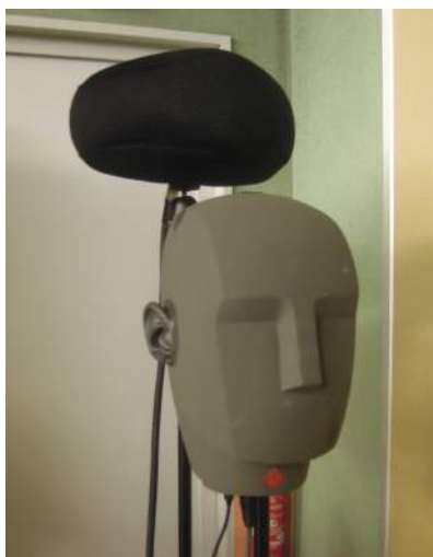
FIGURE 6 : TÊTE ARTIFICIELLE KU100 SURMONTÉE DU MICROPHONE DPA 5100.
