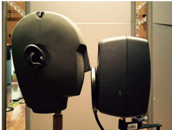
FIGURE 10 : PRISE DE SON, PAR UNE TÊTE ARTIFICIELLE, D'UNE VOIX MONO DIFFUSÉE PAR ENCEINTE
