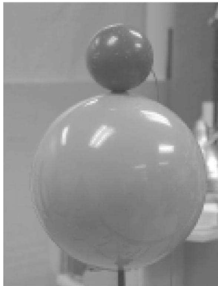
FIG. III.11 – Réplique physique du modèle Snowman . La tête est réalisée avec une balle de croquet de 4.15 cm de rayon et le torse avec une boule de bowling de 10.9 cm de rayon [Algazi and Duda (2002)].
