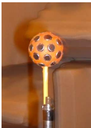
FIG. I.19 – Prototype de microphone ambisonique pour les ordres de décompositions supérieurs.
