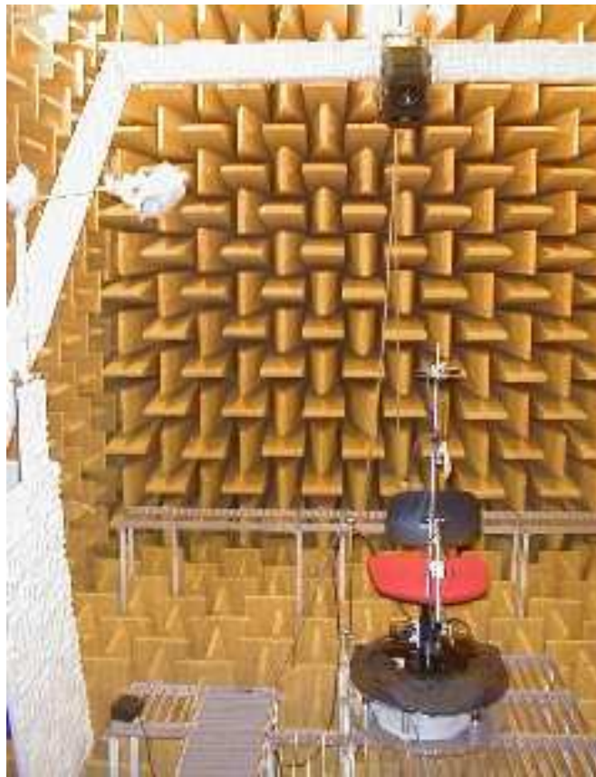
FIG. III.5 – Système de mesure de HRTF pour la base de données LISTEN (cf. http://recherche.ircam.fr/equipes/salles/listen/system/protocol.html ).
