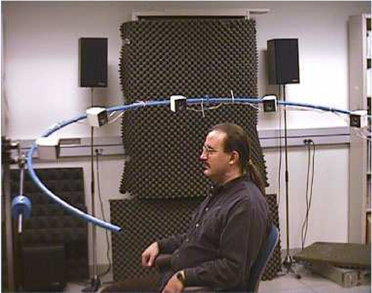
FIG. III.6 – Système de mesures de HRTF pour la base de données CIPIC.
