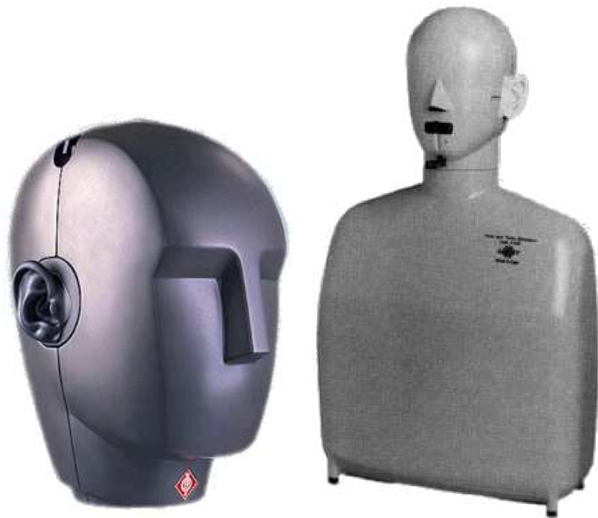
FIG. I.23 – Têtes artificielles pour la technique binaurale.
