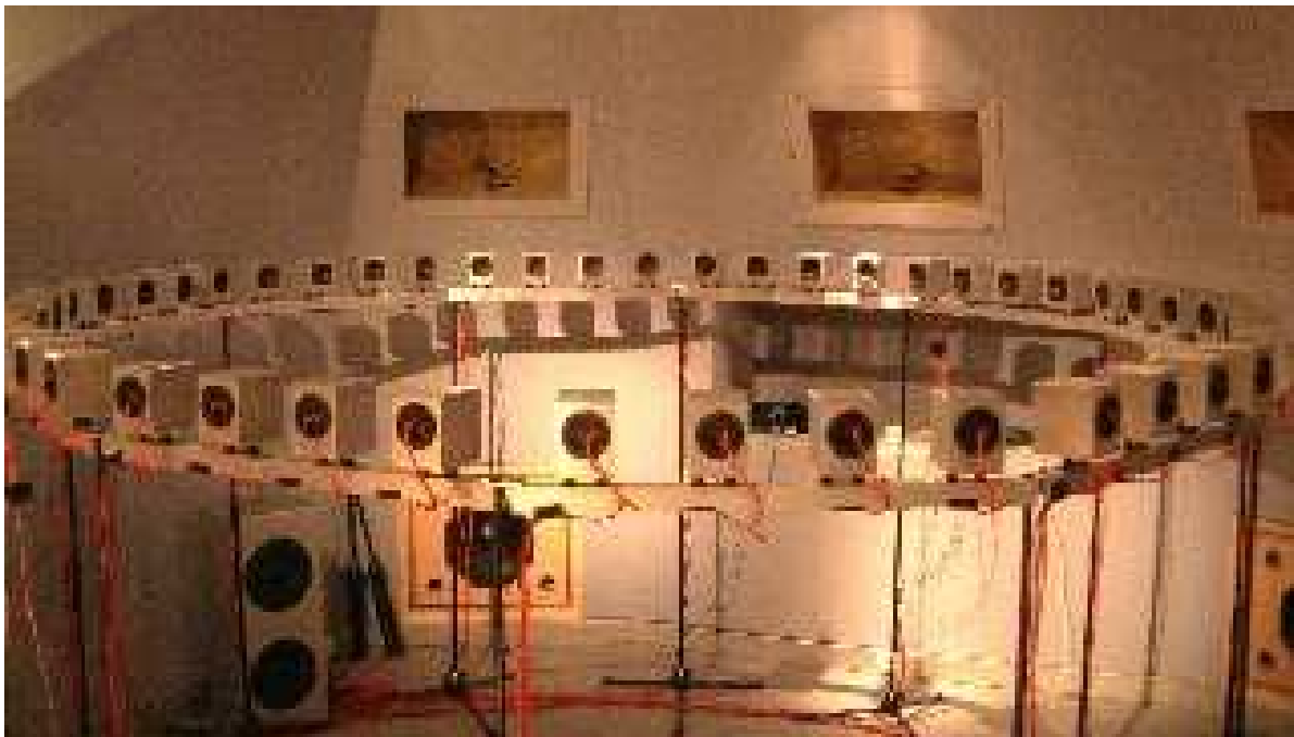
FIG. I.21 – Réseau de 48 hauts-parleurs pour une restitution holophonique.
