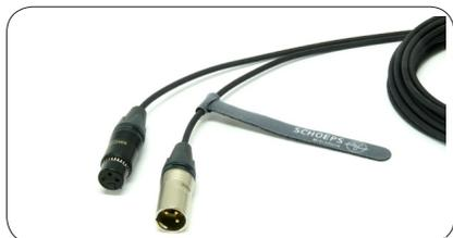
**Câbles microphones EMC** - Les filtres intégrés aux nouveaux câbles de type « EMC » offrent une exceptionnelle immunité aux interférences HF de toute origine, et règlent aussi efficacement les problèmes de boucle de masse. Les fibres en Kevlar, la double tresse de masse et le revêtement en graphite renforcent encore la protection HF et la solidité du câble.
