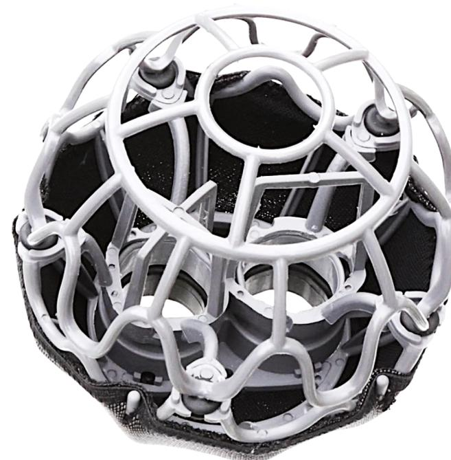
Protection anti-vent pour couple **MS Schoeps CMC + CCM8**. Utilisation exclusive avec suspension spécifique **OSIX 2MS** ou **OSIX 2MS-CAM** (version caméra). Le micro **CMC** à corps standard peut être remplacé par un **CCM** miniature sur adaptateur **CCM-CMC** (Réf. A-CCM-CMC).
