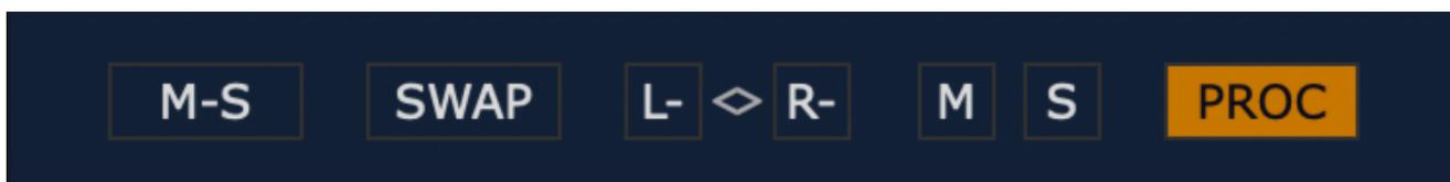
**M-S** – Allume le décodeur M-S à l'entrée du plug-in. Cela permet de décoder les enregistrements Mid-Side ou les pistes encodées en stéréo L/R (gauche/droite) conventionnelle.
