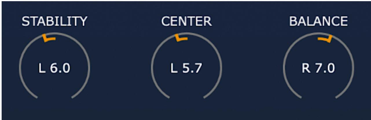
**STABILITÉ** – ajuste l'équilibre des signaux latéraux gauche et droit sans affecter l'emplacement du signal panoramique central. Il est utile pour ajuster le champ stéréo d'un enregistrement multi-instrumental qui a été capturé par une seule paire de microphones *(travaille sur S)*.
