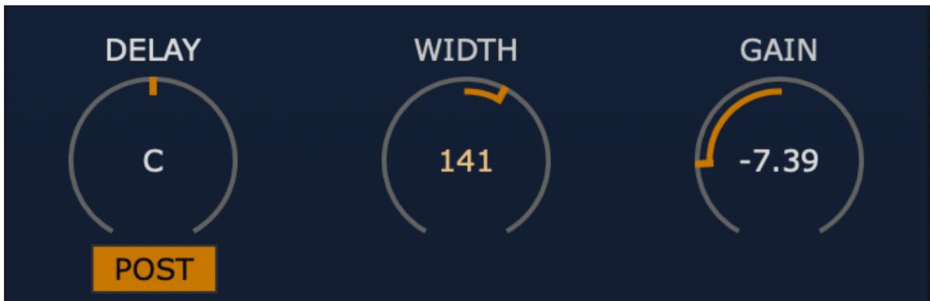
**POST** – Cliquez sur ce bouton pour déplacer le délai à la fin de la chaîne audio, après la stabilité, le centre et la balance (voir les diagrammes pour plus de détails). Lorsque l'auto-test de démarrage (POST) est activé, vous pouvez régler intentionnellement le délai entre les signaux stéréo correctement enregistrés, au lieu de corriger les alignements temporels lorsque l'auto-test de démarrage (POST) est désactivé.
