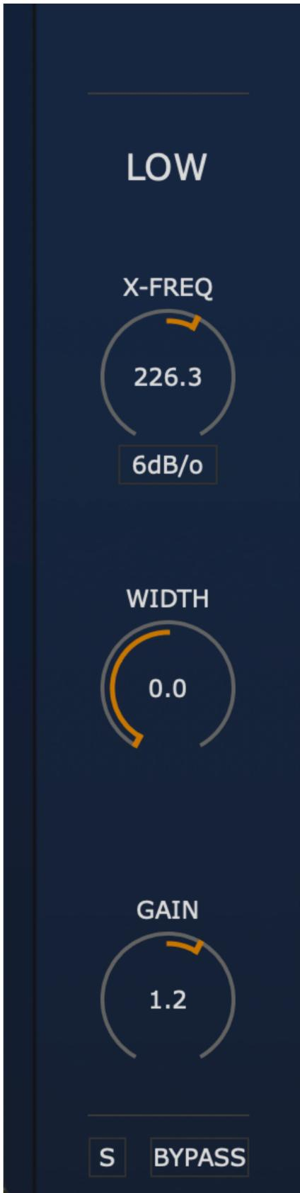
**X-FREQ** – contrôle la fréquence de coupure. Les fréquences inférieures à la fréquence réglée seront traitées en fonction des paramètres Low Width et Low Gain. La gamme de fréquences est de 15 Hz à 1500 Hz ; le réglage par défaut est de 150 Hz.
