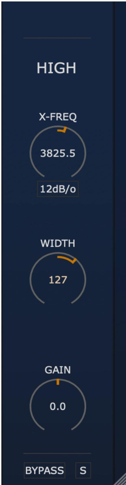
**X-FREQ** – contrôle la fréquence de coupure. Les fréquences au-dessus de la fréquence réglée seront traitées en fonction des paramètres High Width et High Gain. La gamme de fréquences est de 300 Hz à 30 kHz, avec 3000 Hz comme réglage par défaut.
