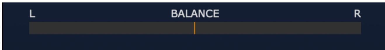
**Compteur d'équilibre** - indique le rapport entre le niveau du signal gauche et droit. Si le relevé du compteur reste près du centre, les canaux L et R sont bien équilibrés. Les relevés du compteur à gauche ou à droite indiquent quel canal est le plus fort.
