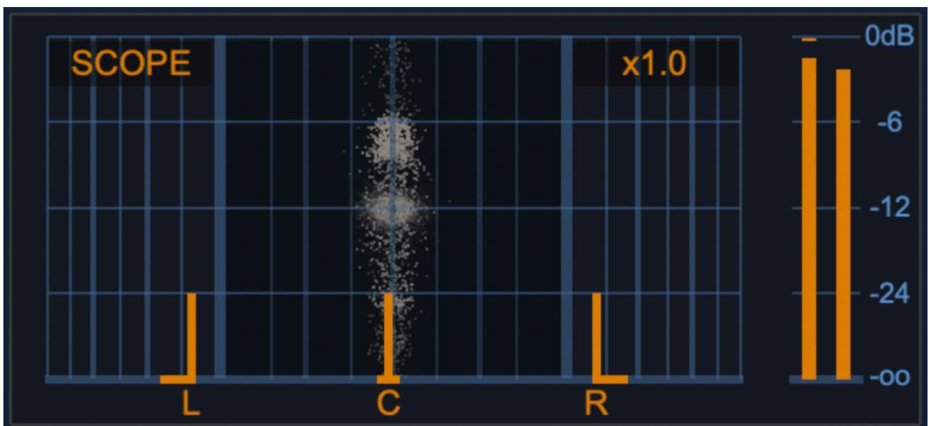
**SCOPE** – l'oscilloscope du goniomètre est enclenché lorsque cette étiquette est orange. Cliquez sur SCOPE pour activer ou désactiver le goniomètre.
