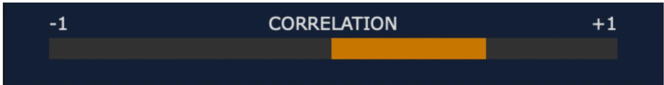
**Compteur de corrélation** – indique le rapport entre les composantes Mid et Side du signal stéréo. Plus d'audio Mid (L+R mono) déplacera le compteur vers la droite +1 indique un signal mono.
